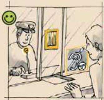
• Si présence d'un guichet avec communication sonorisée, prévoir l'installation d'un dispositif d'interphonie muni d'une boucle magnétique permettant l'amplification du son en faveur de personnes munies d'une prothèse auditive analogique.
